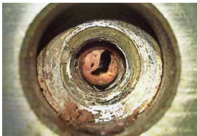
Wirksamer Schutz: Ablagerungen an Temperierkanälen verhindern Innenbeschichtungen beispielsweise mit einer Antihafschicht oder mit Chemisch Nickel Foto: GTT Steinko
