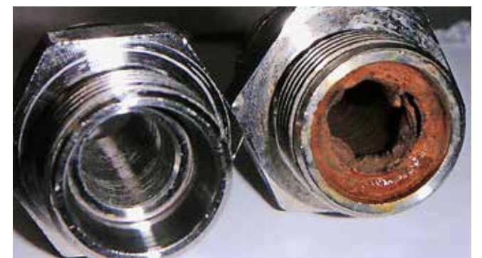
Wirksamer Schutz: Ablagerungen an Temperierkanälen verhindern Innenbeschichtungen beispielsweise mit einer Antihafschicht oder mit Chemisch Nickel Foto: GTT Steinko
