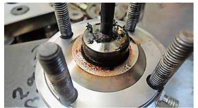
Leckage an Heißkanaldüse durch Überhitzung Foto: GTT Steinko
