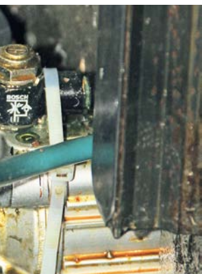
Abgerissener Luftschlauch, wie er bei der planmäßigen Reinigung aufgefallen ist
